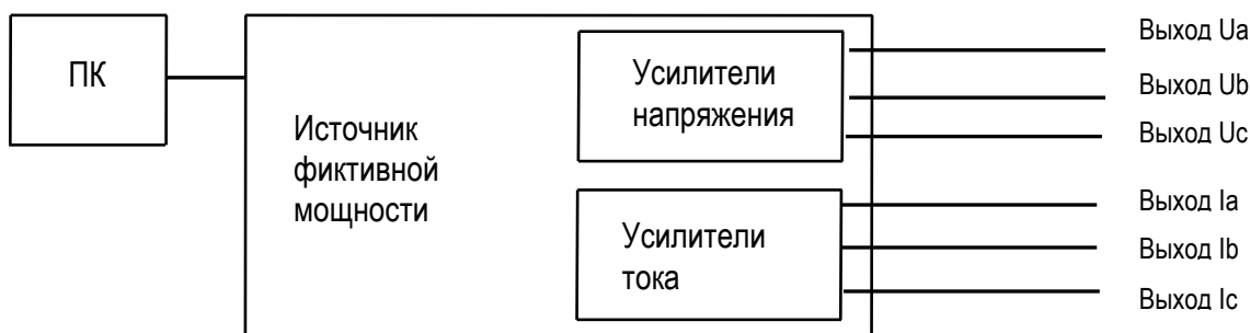
Рисунок 1.1 Структурная схема переносной установки НЕВА-Тест 3303П
